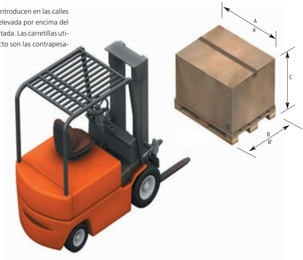
A diferencia del sistema convencional, las paletas se han de manipular en sentido perpendicular a sus patines inferiores. En estanterías de paletización compacta, la carretilla deposita la paleta asentando los patines inferiores en los carriles de apoyo. El esfuerzo de los patines inferiores es muy alto, por lo que las paletas que se utilicen deben estar en óptimas condiciones.
