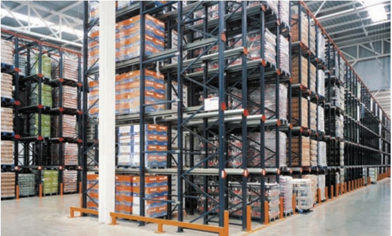
Cuando las cargas depositadas en las estanterías se gestionan por el tipo Drive-through, es decir, la carga se introduce por un lado y se extrae por el contrario, se siguen colocando los arriostros horizontales y los verticales se sustituyen por estructuras de rigidización (figura 6).
