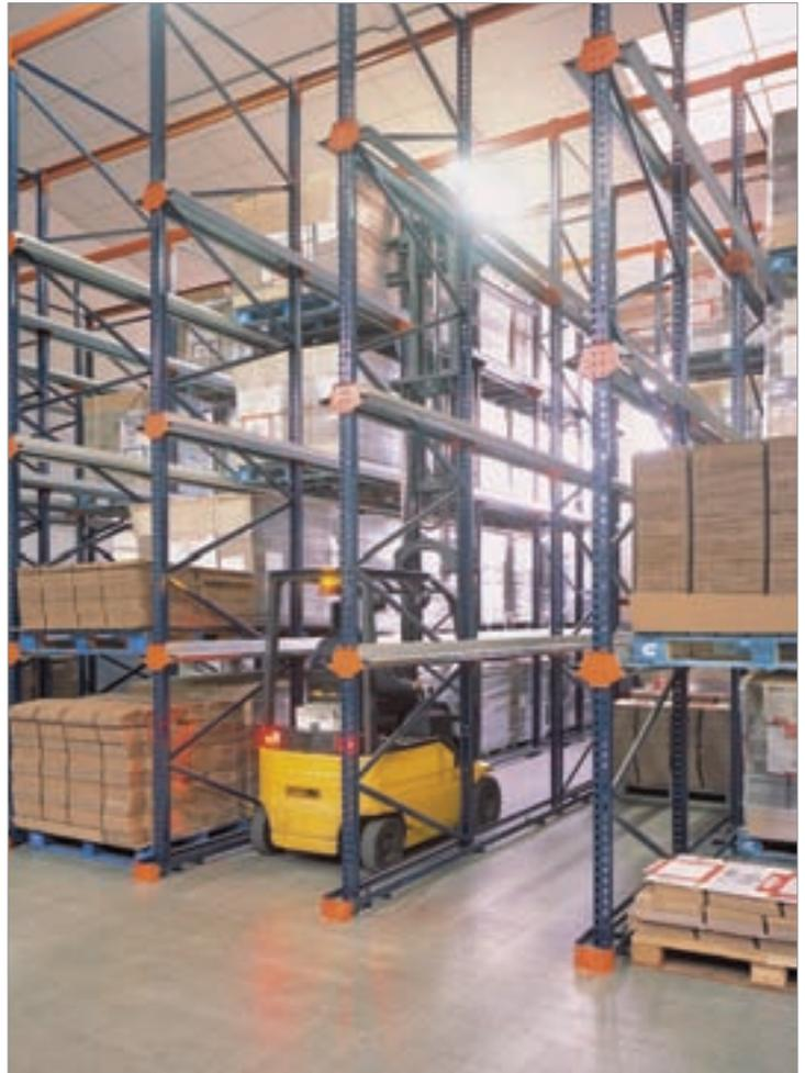
El sistema más usual es el que utiliza perfiles LPN50 asentados sobre soportes fijados al suelo, con punteras de centrado colocadas al frente de las estanterías. Éstas se unen a los perfiles y también se anclan al suelo.
