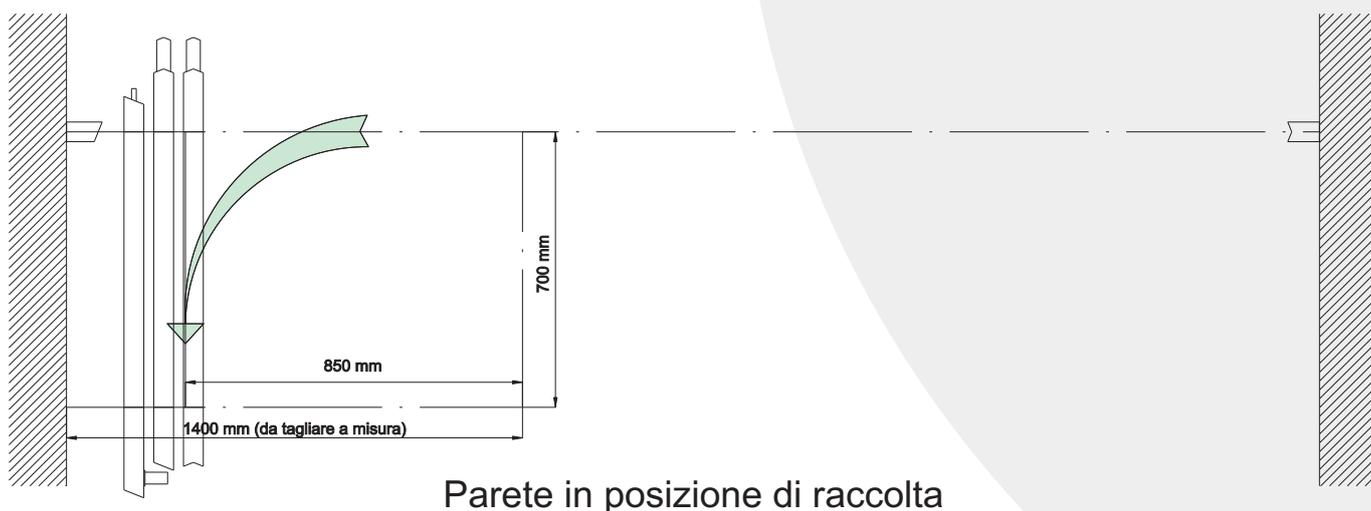
Nell'esempio riportato la parete è composta da 1 montante con battuta, 1 elemento di chiusura Battuta/Battuta, 1 elemento standard Battuta/Maschio, 1 elemento standard Maschio/Femmina e 1 montante Femmina.
