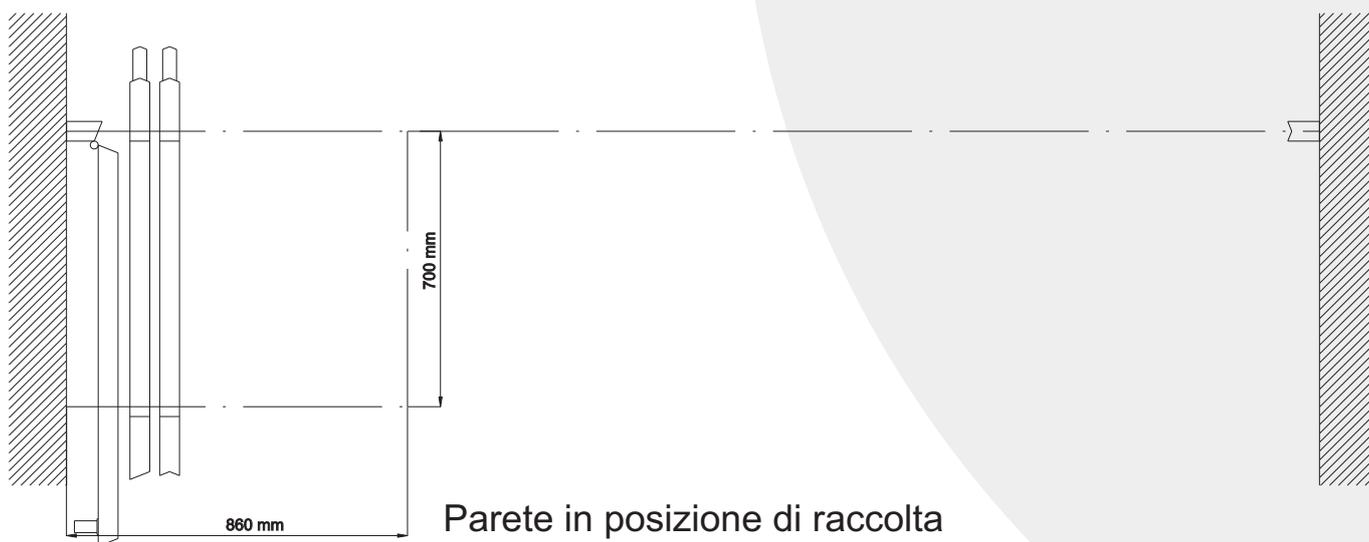
Nell'esempio riportato la parete è composta da 1 elemento con porta fissata al muro, 1 elemento standard Battuta/Maschio, 1 elemento standard Maschio/Femmina e 1 montante Femmina.
