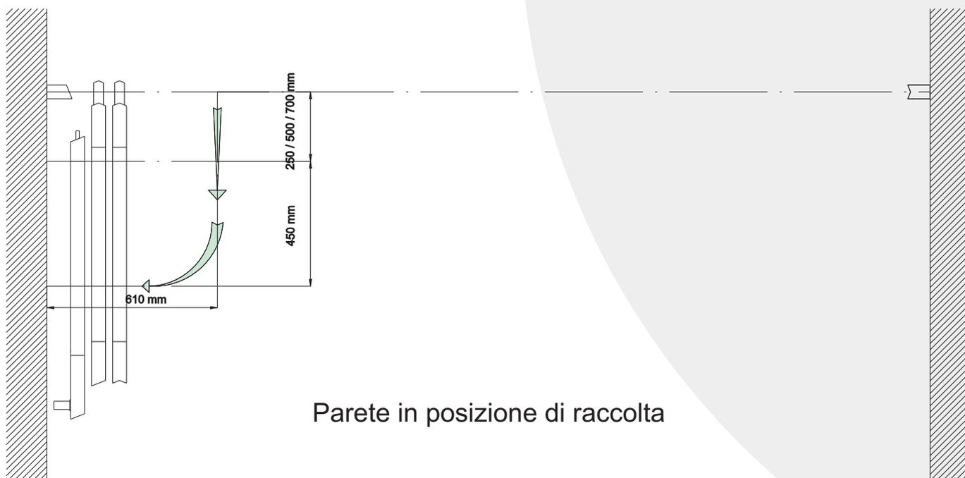
Nell'esempio riportato la parete è composta da 1 montante con battuta, 1 elemento di chiusura Battuta/Battuta, 1 elemento standard Battuta/Maschio, 1 elemento standard Maschio/Femmina e 1 montante Femmina.
