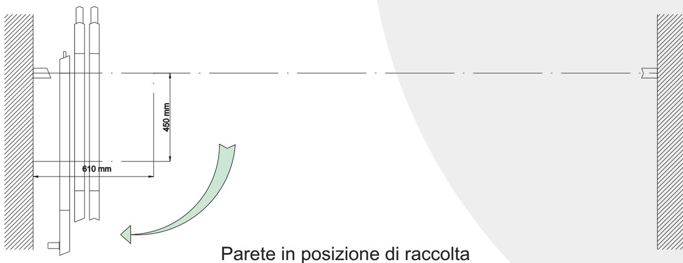
Nell'esempio riportato la parete è composta da 1 montante con battuta, 1 elemento di chiusura Battuta/Battuta, 1 elemento standard Battuta/Maschio, 1 elemento standard Maschio/Femmina e 1 montante Femmina.
