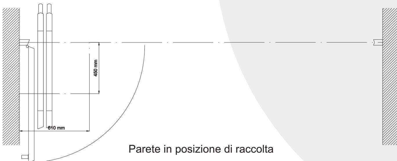
Nell'esempio riportato la parete è composta da 1 elemento con porta fissata al muro, 1 elemento standard Battuta/Maschio, 1 elemento standard Maschio/Femmina e 1 montante Femmina.
